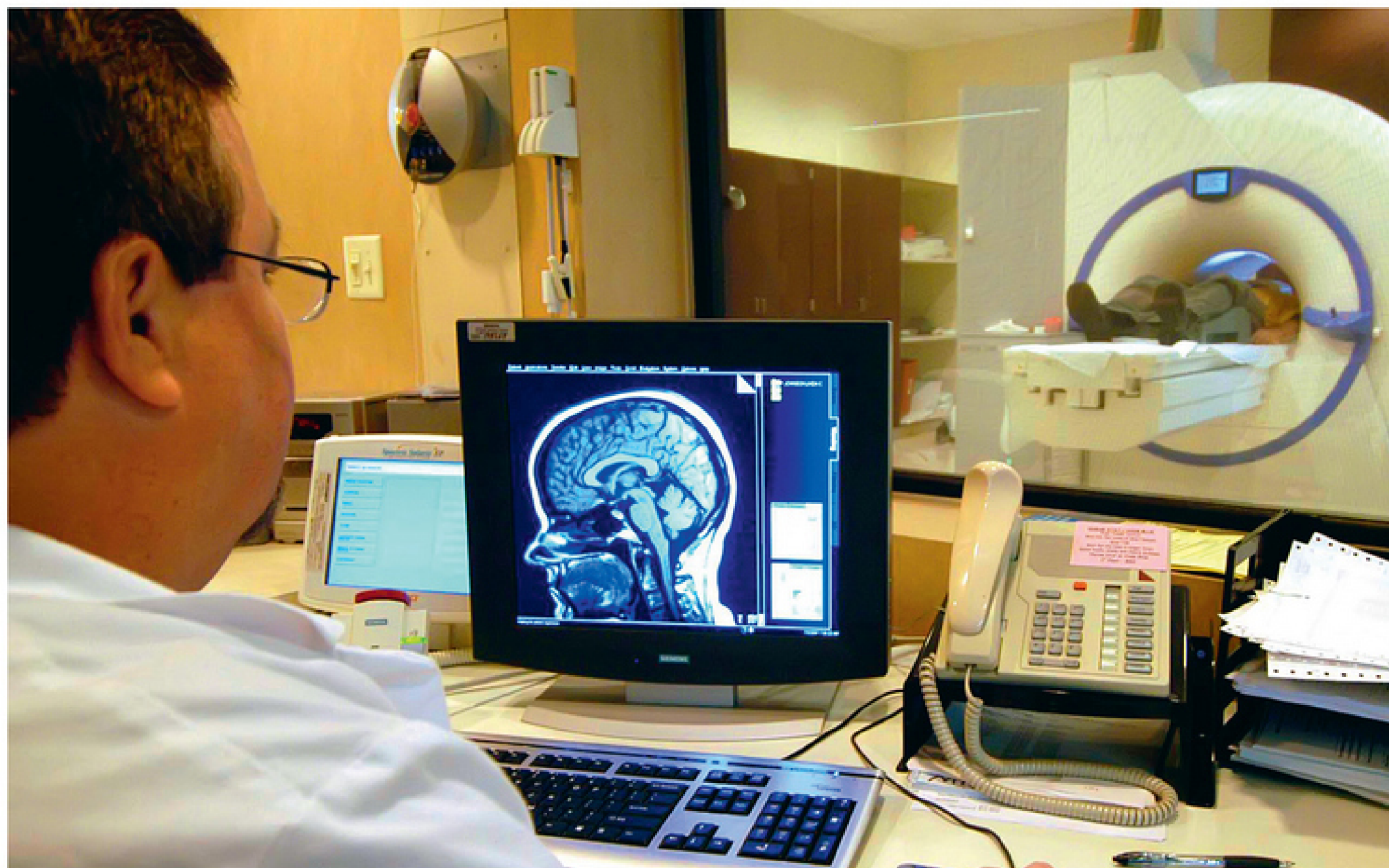
▲ МРТ не делает «фотографий», картинку формируют математические алгоритмы обработки данных на основе «отклика» ядер водорода в магнитном поле. Фото: www.mrtalmaty.kz
